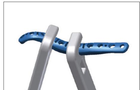
Im Falle der 90° Konfiguration zusätzlich eine posterolaterale Platte posterior auf die laterale Säule des distalen Humerus anbringen. Platte ebenfalls bei Bedarf mit den Biegeeisen (A-2090) an den Knochen modellieren und mit 1.8 mm K-Drähten provisorisch fixieren.
