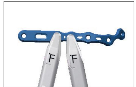
Provisorisch jede Platte mittels einer Kortikalisschraube (A-5800.xx) im Langloch fixieren. Dies erlaubt, die Position der Platte durch temporäres Lösen dieser Schrauben longitudinal später nachzujustieren. Die anmodellierte Platte mit dieser Schraube an den Knochen ziehen.
