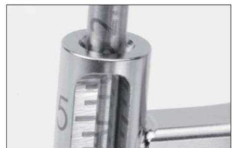
An der Skala der Bohrerführung A-2722 kann in Verbindung mit der schwarzen Markierung am Bohrerschaft der Spiralbohrer (A-3713, A-3723, A-3733) die benötigte Schraubenlänge abgelesen werden.
