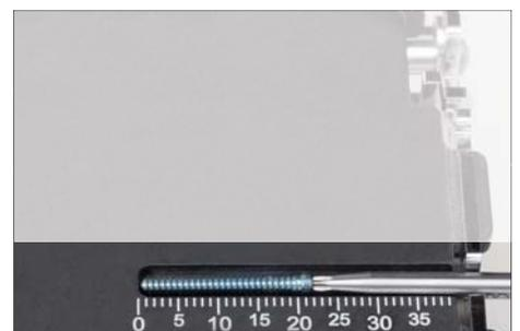
Schraubenslänge und -durchmesser am Längenmessmodul kontrollieren. Die Schraubelänge wird am Kopfende abgelesen.
